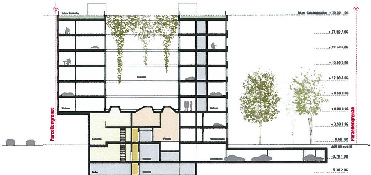
Abbildung: Schnitt durch das Gebäude mit Atrium und Arkade zur Schaffhauerstrasse.
