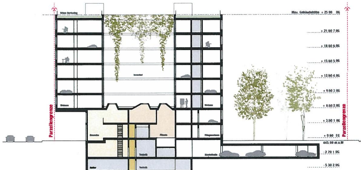
Abbildung: Schnitt durch das Gebäude mit Atrium und Arkade zur Schaffhauserstrasse.
