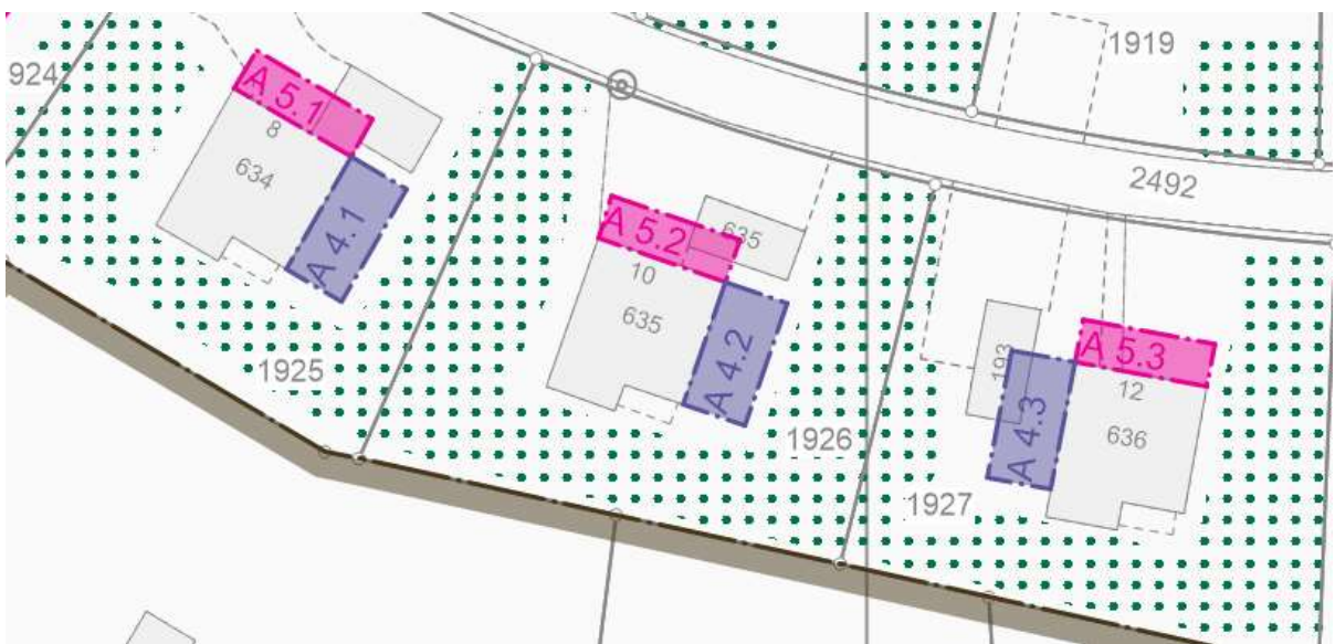
Abbildung 22: Perimeter für zweigeschossige Anbauten bei Einfamilienhäusern
