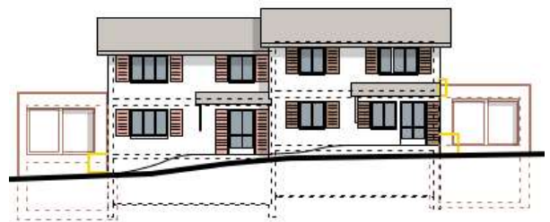
Abbildung 21: Ansicht mit Anbau seitlich
