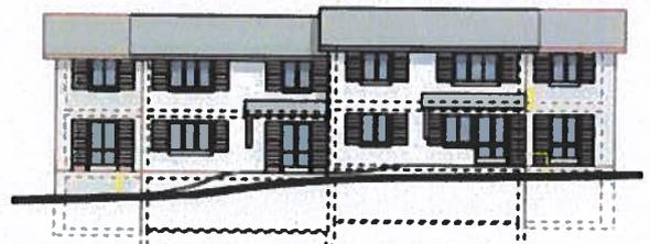
Abbildung 4: giebelseitiger, zweigeschossiger Anbau bei einem Doppel Einfamilienhaus mit je rund 56 m<sup>2</sup> Erweiterungsfläche
