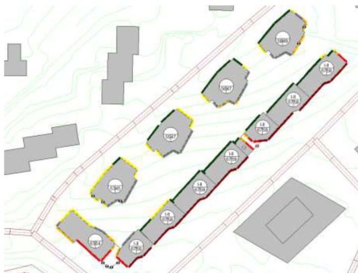
Abbildung 8: Übersicht Situation Richtprojekt, Höhe Lärmriegel 7 m, die Grenzwerte bei den Punktbauteilen sind überall eingehalten.
