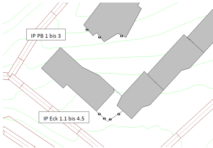
Abbildung 6: Modellierung der Eckbaute als schwebende Schirme, Erfassung der Fassadenbelastung mit Immissionspunkten, Darstellung im Grundriss.
