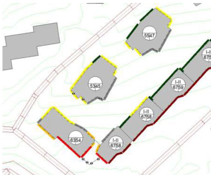
Abbildung 10: Situation Richtprojekt Südwest, Höhe Lärmriegel 7 m, die Grenzwerte sind am Tag und in der Nacht eingehalten.
