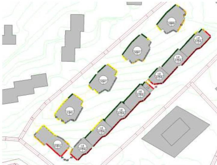
Abbildung 8: Übersicht Situation Richtprojekt, Höhe Lärmriegel 7 m, die Grenzwerte bei den Punktbauteilen sind überall eingehalten.
