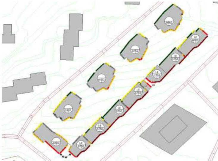
Abbildung 1: Übersicht Situation Richtprojekt mit 2-geschossigem Lärmriegel, die Grenzwerte sind in den Punktbauten in der Nacht und teilweise auch am Tag überschritten.
