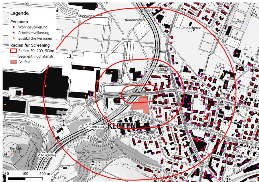
Abbildung 5: Analysiertes Segment der Flughafenstrasse mit den Abstandsbereichen 50 m, 200 m und 500 m für die Berücksichtigung der Personenbelegung gemäss Screening Methodik.
