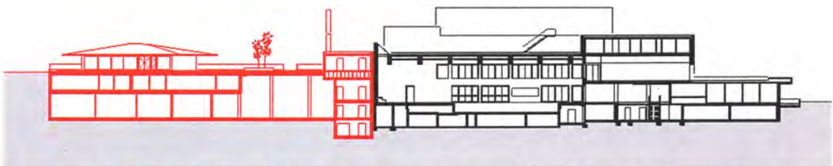
Schnitt längs durch den Bau der neuen Ausführung Wärmeerzeugung ausschliesslich mittels Erdwärmesonden
