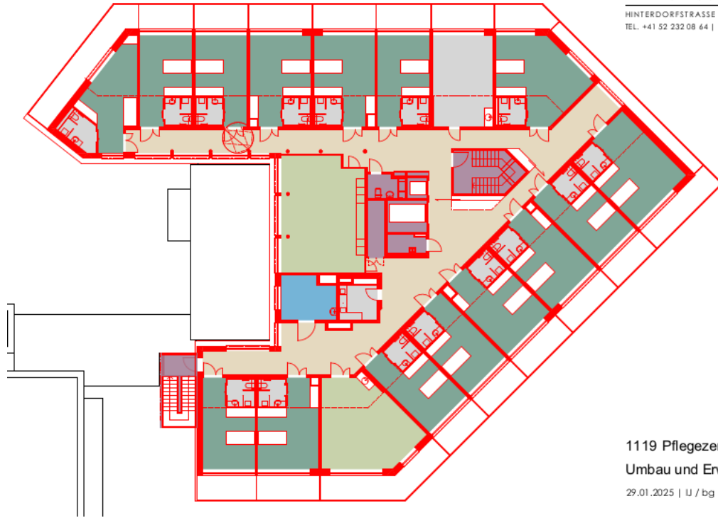
Grundriss 5. Obergeschoss: Aufstockung – neues Geschoss mit Zimmern und Aktivierungsraum
