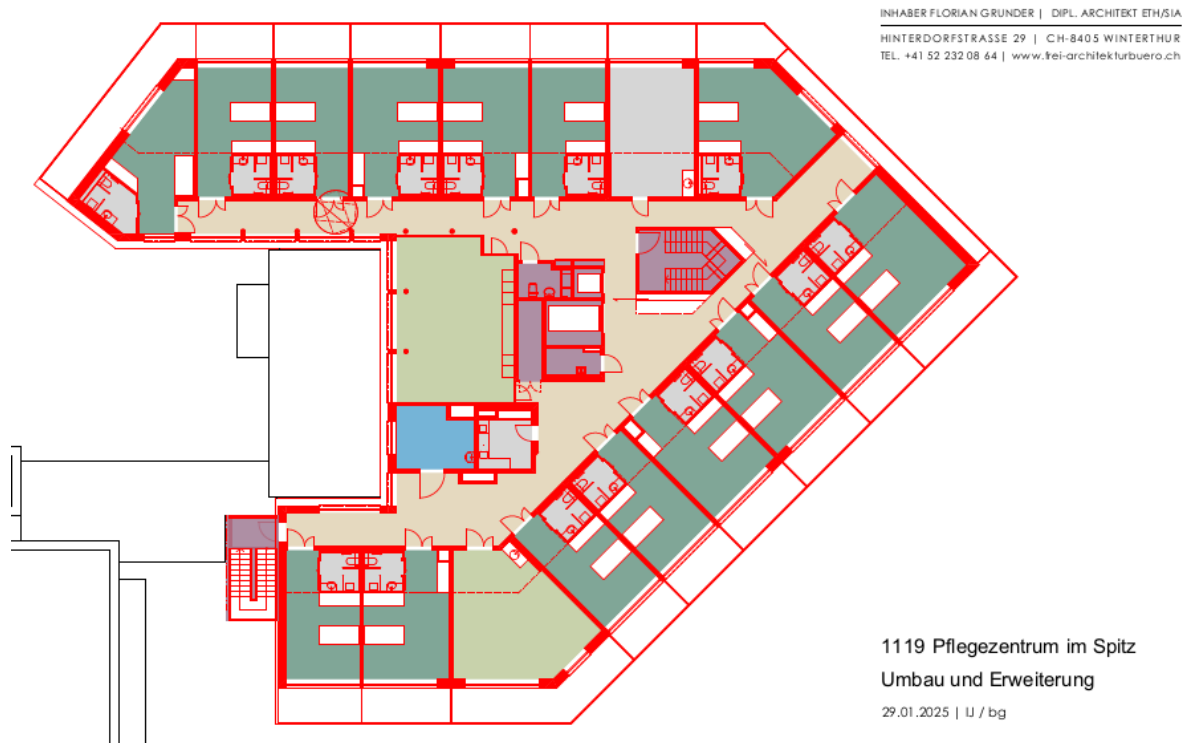
Grundriss 5. Obergeschoss: Aufstockung – neues Geschoss mit Zimmern und Aktivierungsraum
