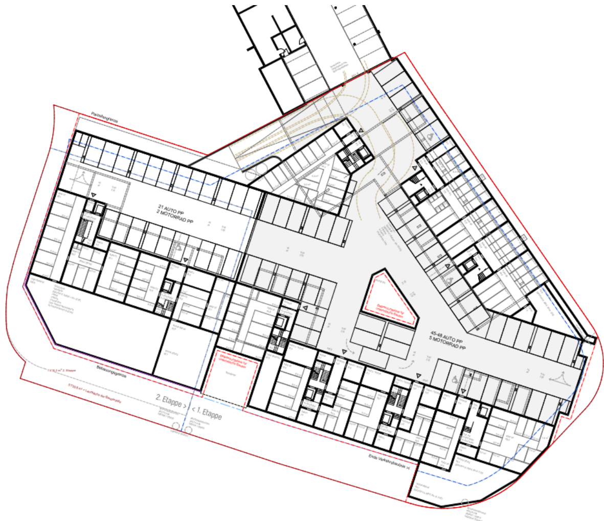
Abbildung 1: Einstellhalle im Untergeschoss[6]
