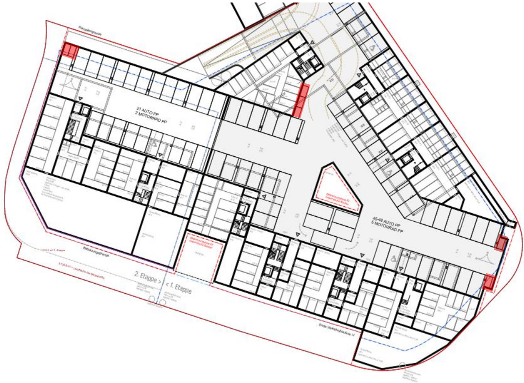
Abbildung 4: Motorradabstellplätze im Untergeschoss
