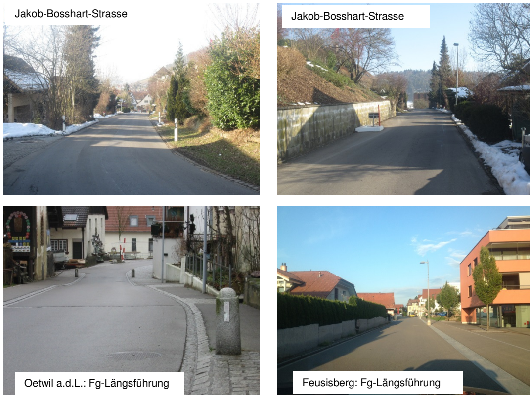
Abbildung 13 Fussgängerlängsführung: mögliche Gestaltung: Fg-Längsstreifen
